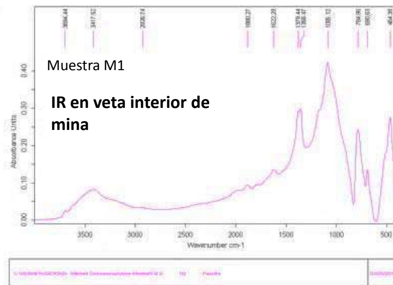
Figura 33.- Espectros infrarrojos de las muestras H2 (Traza en superficie) y M1 (interior de mina) identificando minerales de la serie cuarzo-esmectita.
