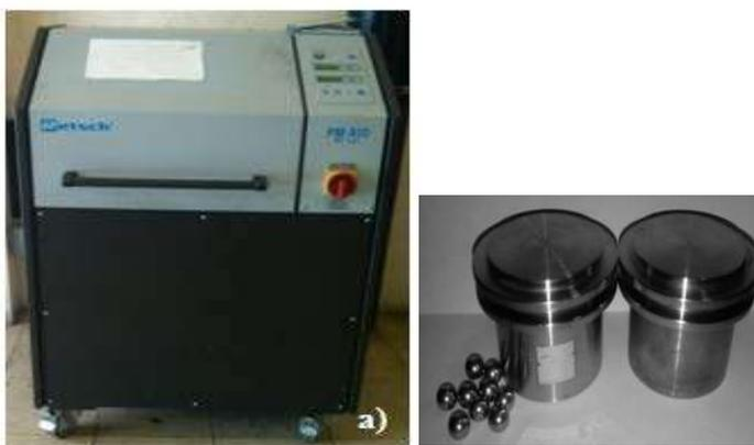
**Figura 3.1** a) Molino planetario de alta energía RESTCH PM 400 MA y b) contenedores de acero inoxidable.
