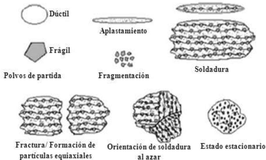
**Figura 2.3** Diferentes etapas de un sistema dúctil/frágil durante aleación mecánica <sup>[36]</sup>.
