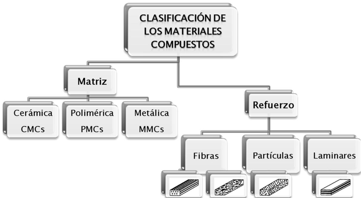
**Figura 2.2** Clasificación de los materiales compuestos de acuerdo con el tipo de matriz y el tipo de refuerzo que contengan <sup>[1]</sup>.
