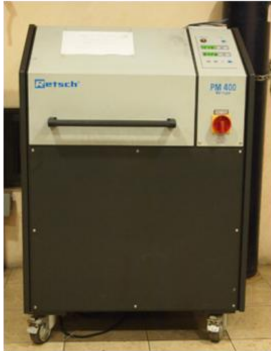
Figura 3.2 Molino planetario de alta energía RESTCH PM 400 MA y contenedores.
