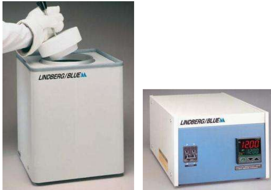
Figura AII.3 Horno tipo crisol y controlador PID de temperatura máxima 1200°C, empleado como cámara de calentamiento del compactado precursor de espuma.
