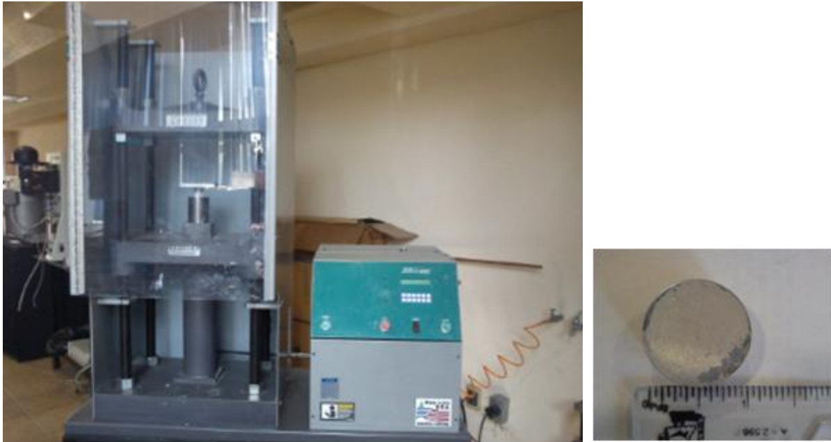
Figura 3.3 a) Prensa hidráulica automática CARVER 3894.4PR0B00. b) compacto precursor Al-TiH 2 .
