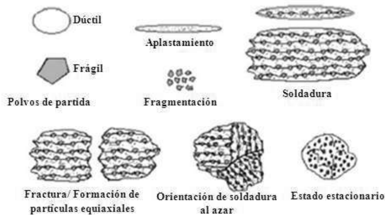
Figura 2.17 Diferentes etapas de un sistema dúctil/frágil durante aleación mecánica [21].
