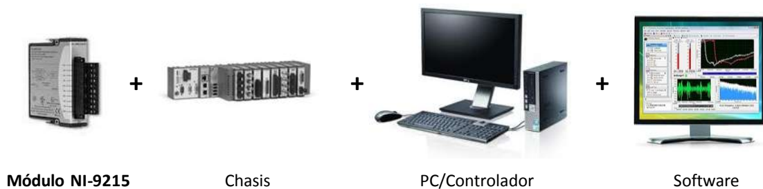
Figura AII.4 Arreglo de sistema con Módulo NI-9215 para adquisición de datos.
