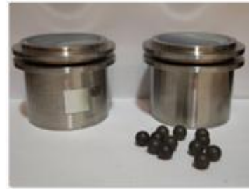
Figura 3.2 Molino planetario de alta energía RESTCH PM 400 MA y contenedores.
