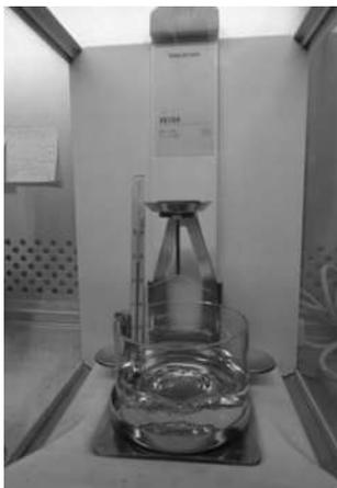
**Figura 2.7.** Equipo de medición de densidad.
