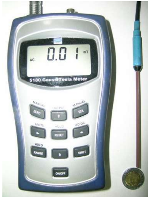
Figura 18. Gausímetro empleado para medir el campo magnético inducido durante la soldadura.
