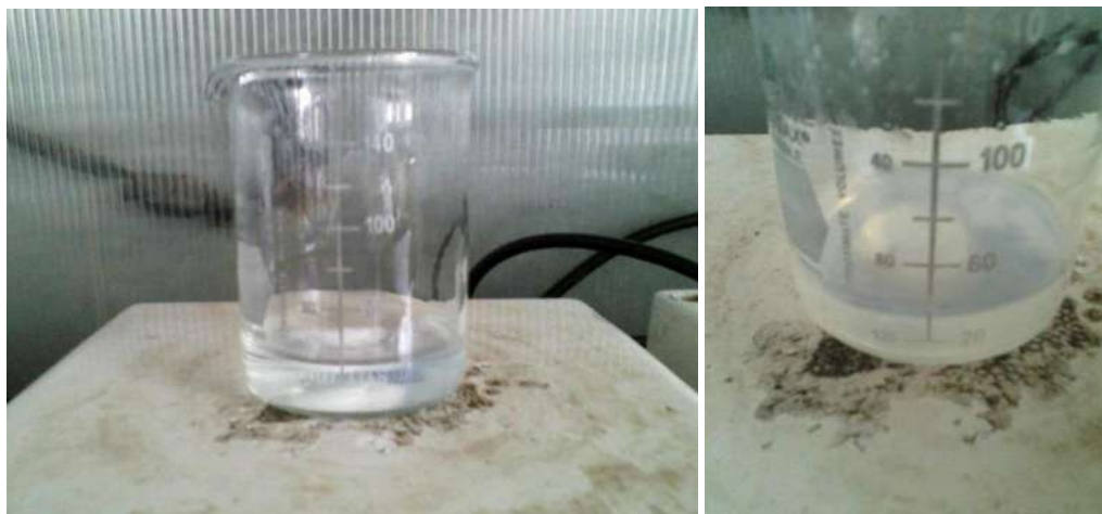
Figura 3.3. Proceso de síntesis de partículas de \text{TiO}_2 , (a) agitación constante durante 3 horas y, (b) obtención de una coloración lechosa por la reacción de hidrólisis del precursor de titanio.
