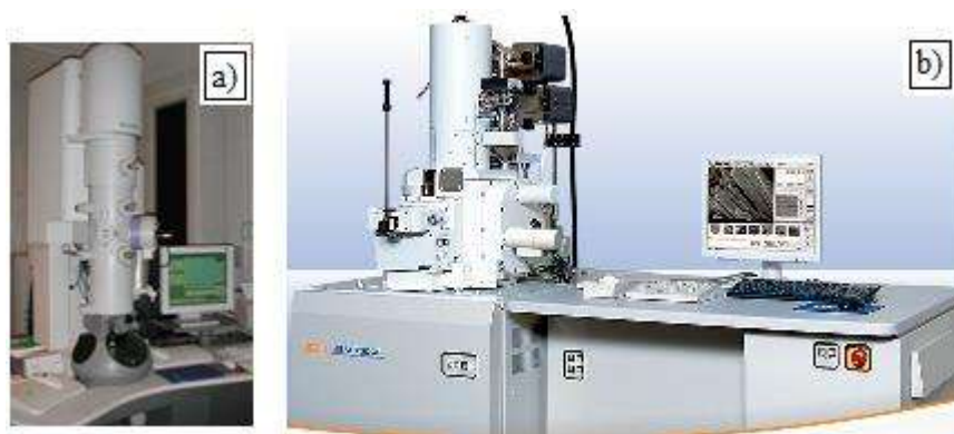
Figura 2.5. a) Microscopio Electrónico de Transmisión Phillips TECNAI F20 y b) Microscopio Electrónico de Barrido JEOL JSM-76000F
