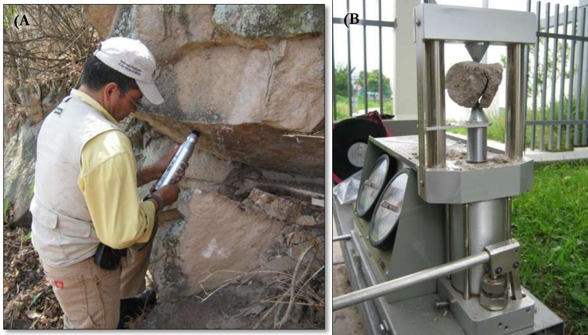
Figura 30.- A) Utilización del martillo de Schmidt en campo. B) Prueba de carga Puntual en las unidades seleccionadas.
