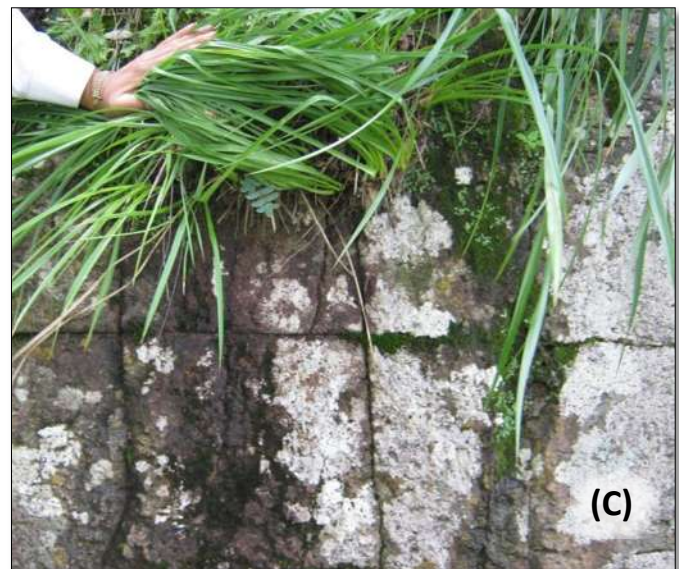
Figura 47.- A) Fracturamiento en el Flujo de Escombros. B) Detalle de un bloque desplazado cerca de 4 cm y C) fracturamiento con aristas a 90° en la Ignimbrita Rosa muy Soldada.
