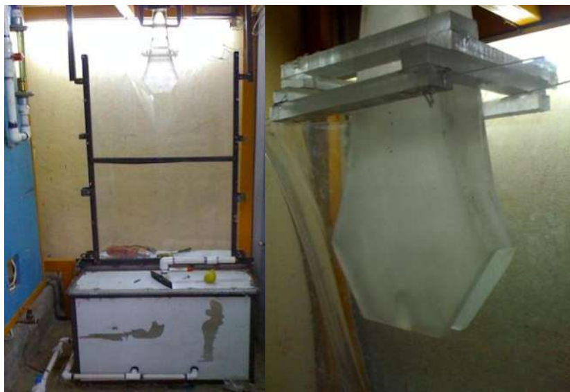
Figura 3.7. Detalles del molde y buza de un modelo de colada continua de PD.
