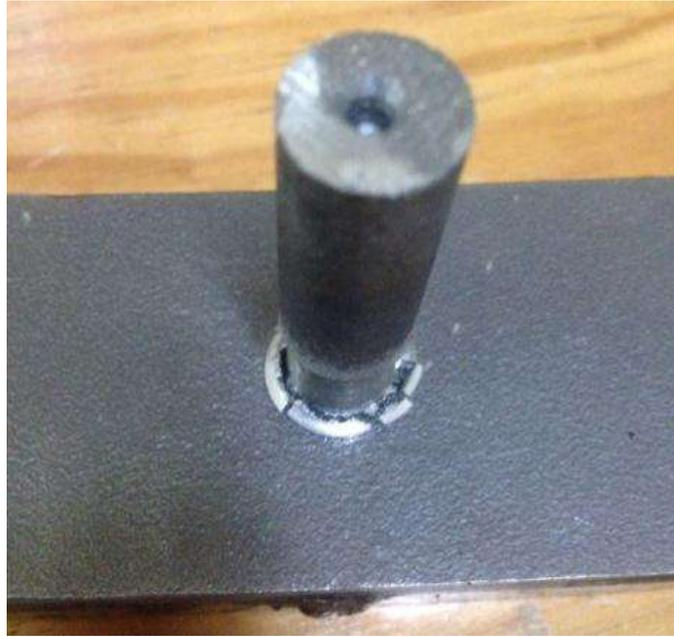
**Figura 4.20.** Ensamble entre el bloque de acero 9840 y las probetas recubiertas.
