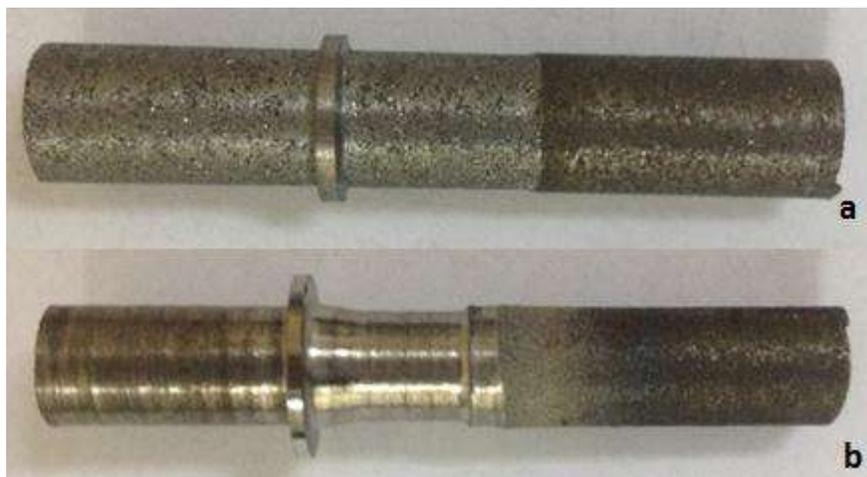
**Figura 4.19.** Probetas para ensayo de corte a) MetaCeram 21032S b) MetaCeram 23065.
