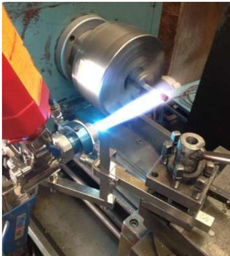
**Figura 3.8.** Arreglo para la aplicación del recubrimiento.
