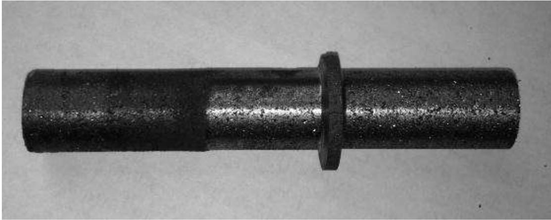
**Figura 3.12.** Probeta maquinada para ensayo de corte.
