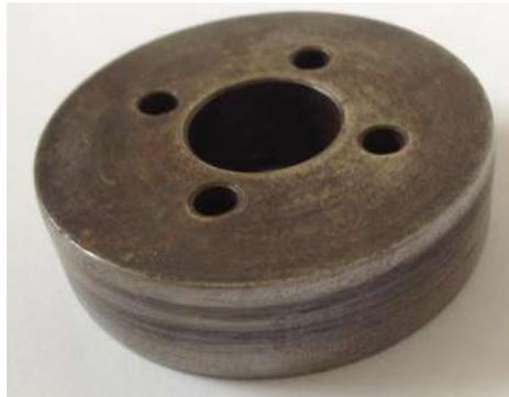
**Figura 3.15.** Contracara de acero M2 tratado térmicamente.
