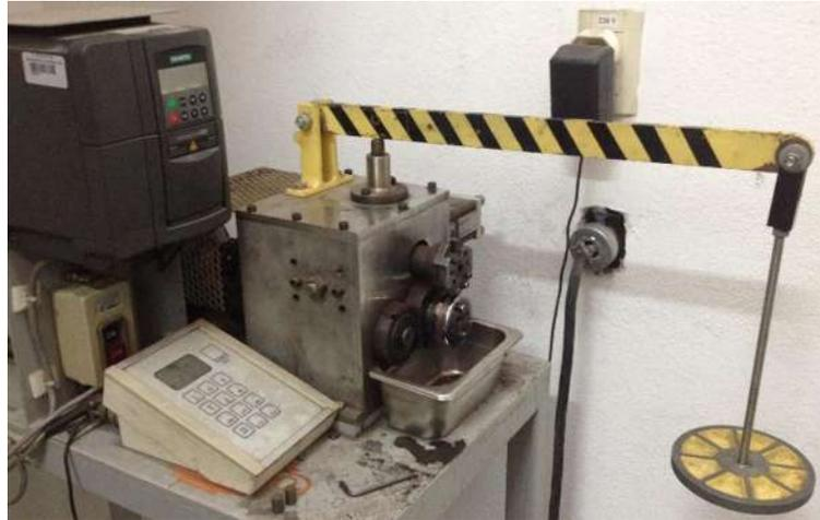
**Figura 3.14.** Máquina utilizada, tipo “perno en anillo” para los ensayos de desgaste.
