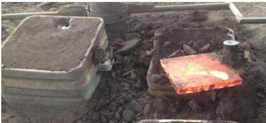
**Figura 3.2.** Elaboración de la fundición con molde de arena
