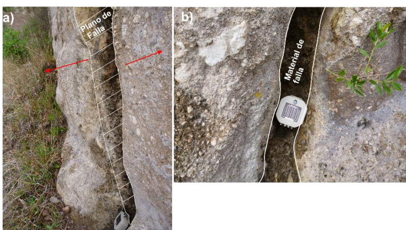
Figura 10. Estación Mesoestructural 2. a) Falla ENE-OSO con bloques desplazados lateralmente y desarrollo de material de falla. b) Plano de falla con abertura y relleno de material de falla, milonita.
