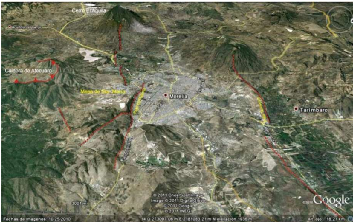
Figura. 2.16. Foto satelital de la ciudad de Morelia (Google Earth). Se observan las dos fallas principales, al sur La Paloma y al norte la falla Tarimbaro, ambas E-O y afectando al vulcanismo monogenético de El Quinceo y El Águila. Dentro de la Ciudad de Morelia las fallas tienen direcciones NE-SO, como las fallas de La Colina y la Central Camionera. Fuente Garduño-Monroy et. al., 2011.
