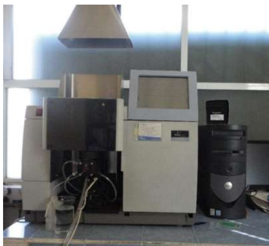
Figura 5.5. Equipo de Absorción Atómica utilizado. PerkinElmer AAnalyst 200
