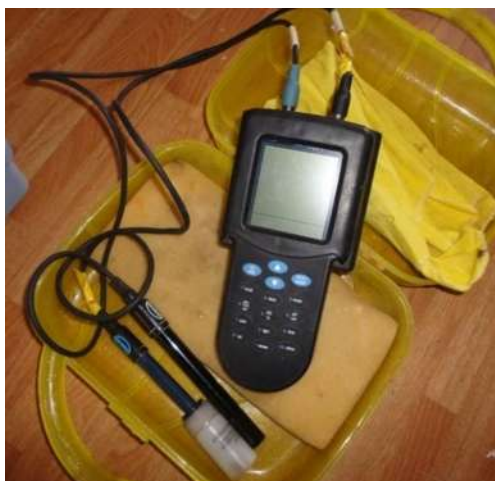
Figura 5.5. Imagen de multiparamétrico sesion156, el cual se utilizó para medir pH, conductividad, salinidad, TDS y temperatura.
