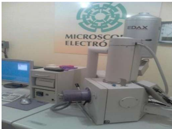
Figura 7. MEB ambiental Philips ESEM XL30 con un equipo acoplado EDAX GENESIS con detector SiLi,10L, 204Bt.
