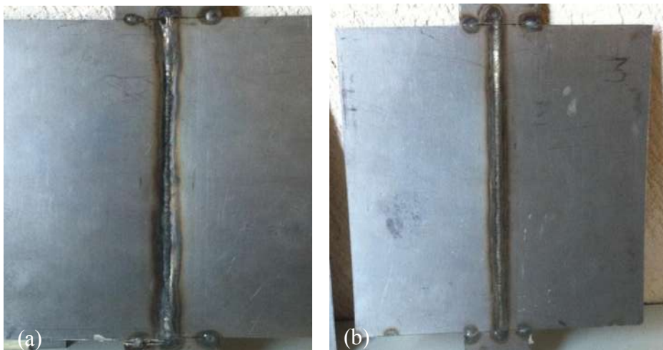
Figura 3.13. Cara de la soldadura y pasada de raíz de la unión soldada tipo A.
