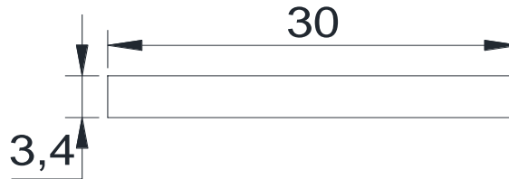
Figura 2.9. Área de análisis en los materiales base para el ensayo de microdureza Vickers.
