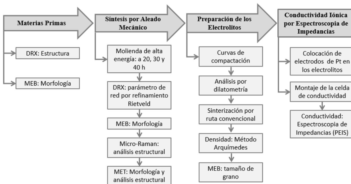
**Figura 3.1** Diagrama esquemático del desarrollo experimental para la preparación de los electrolitos sólidos y su caracterización.
