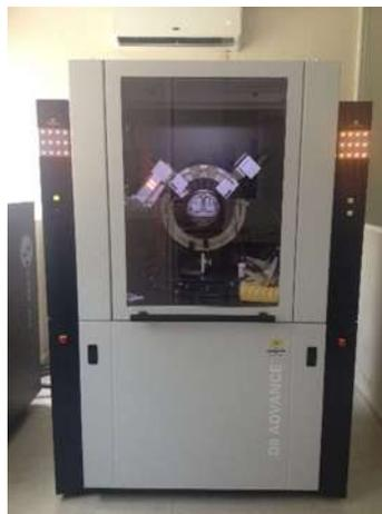
Figura 21. Difractómetro de rayos X D8 Advance.
