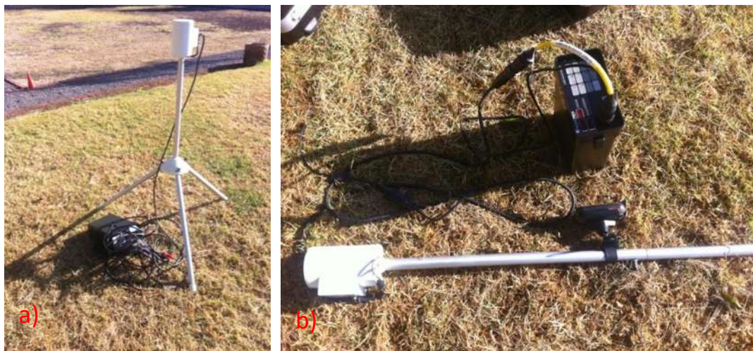
Fig. 24. Se muestran el magnetómetro base (a) y el magnetómetro móvil (b)
