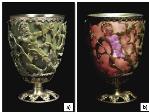
Figura 2.5 La copa de Licurgo se ve verde cuando la luz incide sobre él (a), pero de color rojo cuando la luz brilla dentro (b). La copa contiene nanopartículas de oro [8].
