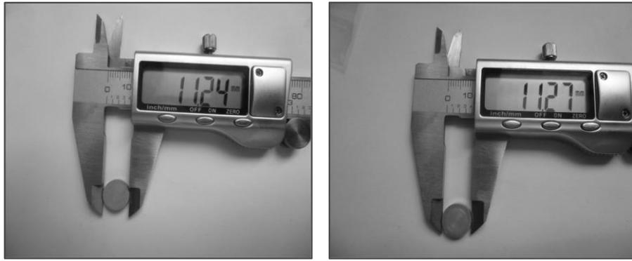
**Figura 4.20** Medición del diámetro de las pastillas en verde utilizando un Vernier digital.
