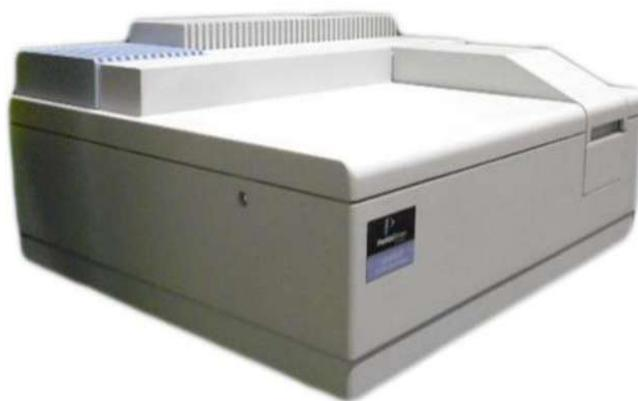
**Figura 3.7.** Espectrómetro UV-Vis lambda 25 marca Perkin-Elmer.
