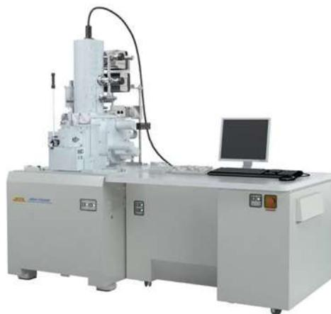
**Figura 3.4.** Microscopio electrónico de barrido de emisión de campo (JEOL JSM-7600F).
