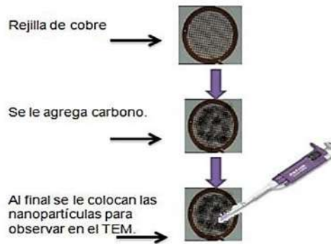
Figura 4.5: Preparación de la muestra en las rejillas para observar en TEM.
