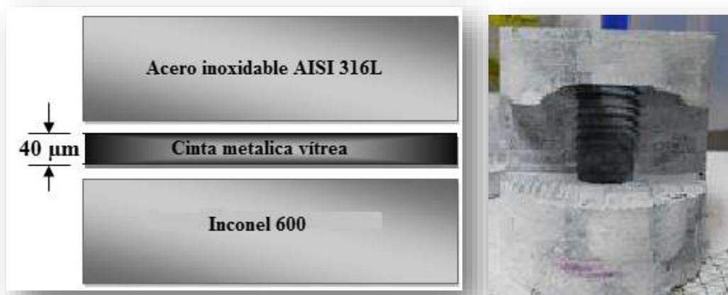
**Figura 3.2** Dados de grafito y arreglo de las muestras a unir AISI 316L/cinta/Inconel 600
