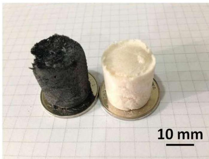
**Figura 2.10** Espuma antes y después del tratamiento para eliminar residuos [37].
