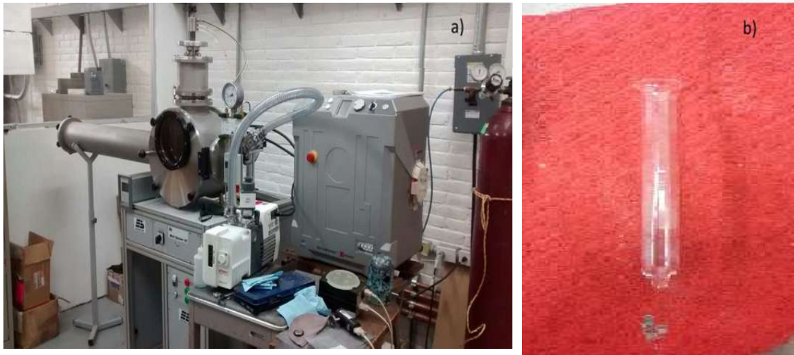
Figura 3.2. a) Imagen de la maquina Melt Spinning SC, b) imagen del crisol de cuarzo en el cual se fundieron las aleaciones.
