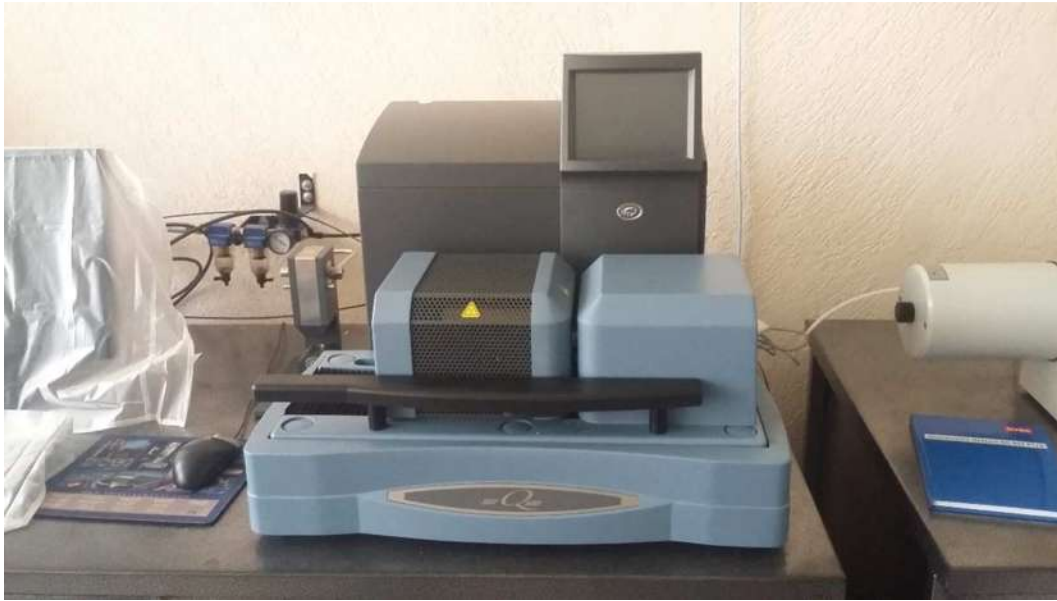
Figura 3.8. Fotografía del equipo DSC-TGA del IIMM.
