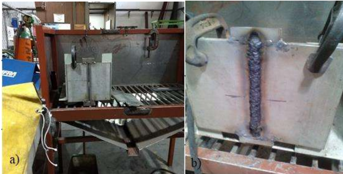
Figura 2.4. a) Antes de unir, y b) después de la aplicación de la soldadura.
