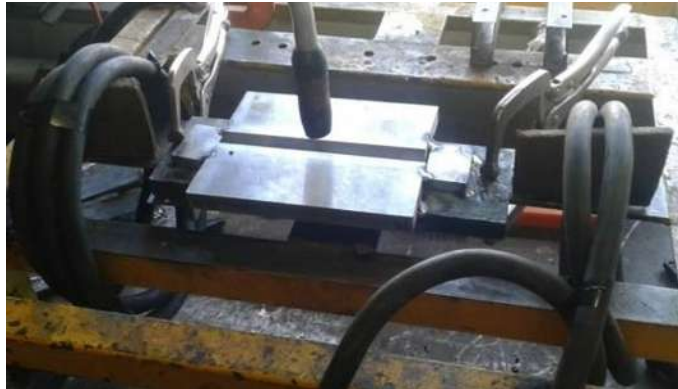
Figura 3.10 Montaje de las placas con bobinas al inicio y fin para depositar el cordón de raíz.
