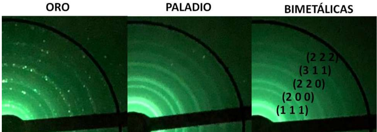
Figura 4.57 Patrones de difracciones de las diferentes nanopartículas obtenidas de forma separada.
