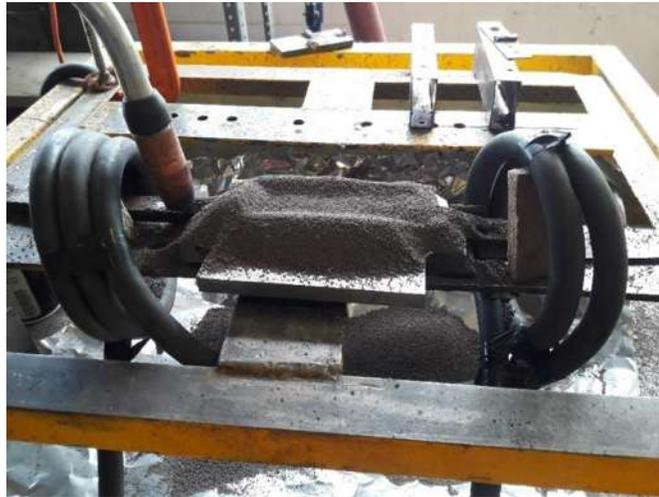
**Figura 3.9** Fotografía del arreglo de las bobinas con las placas para unión.
