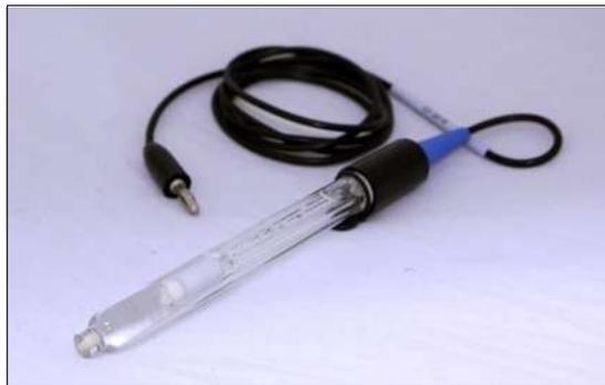
**Figura 3.14** Electrodo de referencia Calomel.
