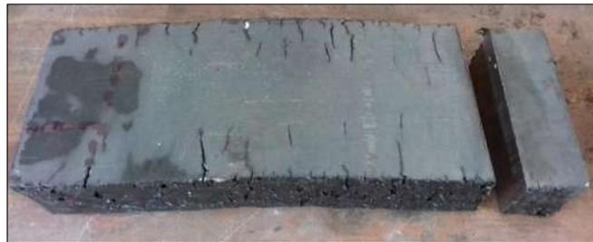
**Figura 4.32** Aleación base laminada con agrietamiento.
