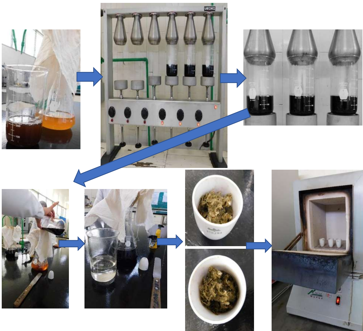
Figura de Anexo 6. Proceso de extracción de fibra presente en los extractos de T. officinale .
