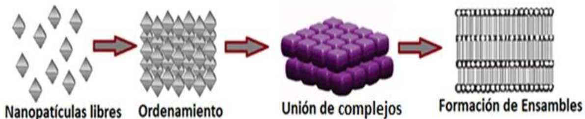
Figura 2. 3 Enlace de nanopartículas para la formación de ensamblés [30].
