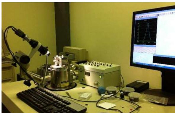
**Figura 3.12** Microscopio de fuerzas atómicas JEOL JSOM-5200 Scanning Probe Microscope.
