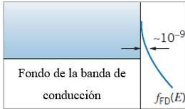
**Figura 2.2** Amplificación de la función de distribución Fermi-Dirac cerca del fondo de la banda de conducción. En la escala de esta ampliación, el valor 1 de  $f_{FD}(E)$  estaría a 1000 km hacia la derecha y la  $E_F$  un metro debajo de esta figura. [1]
