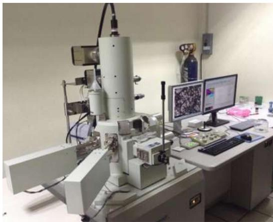
**Figura 3.11** Microscopio electrónico de emisión de campo marca JEOL modelo JSM-7600F FEG-SEM.
