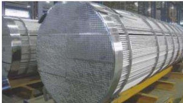
**Figura 2.1** Intercambiador de calor de acero inoxidable [2].
