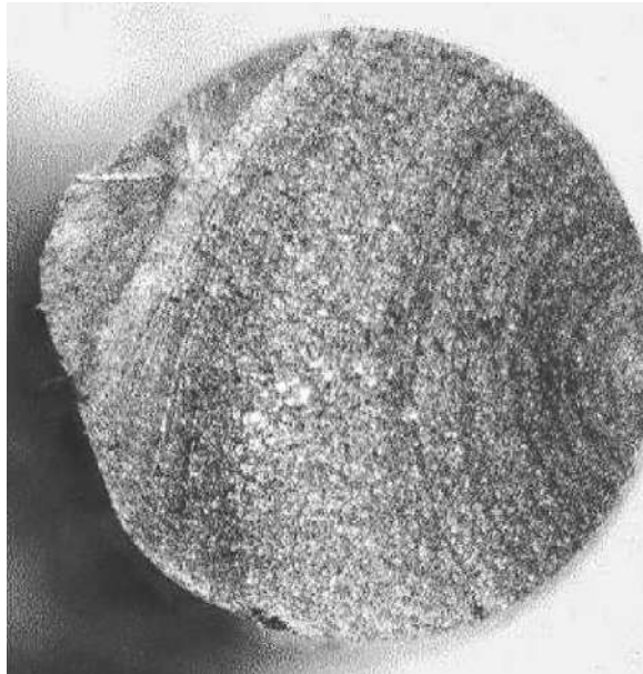
Figura 2.11 Superficie de una fractura por fatiga mostrando líneas características de progresión [33].
