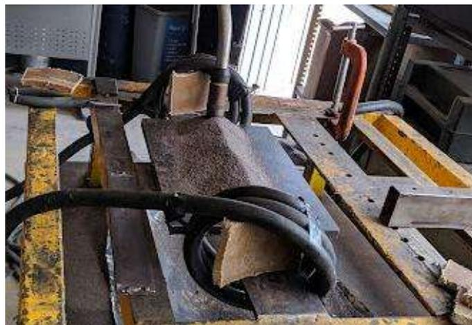
**Figura 3.3** Arreglo experimental del proceso de soldadura de arco sumergido con aplicación de campos magnéticos externos.
