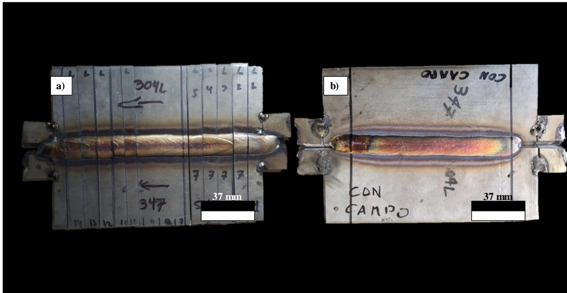
**Figura 4.2** Apariencia superficial de las placas después del proceso de soldadura, a) soldadura convencional, b) soldadura con IEM.
