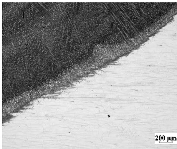
**Figura 4.25.** Imágenes por microscopía óptica de la zona central de la interfase entre el cordón de soldadura y la aleación AL6XN.
