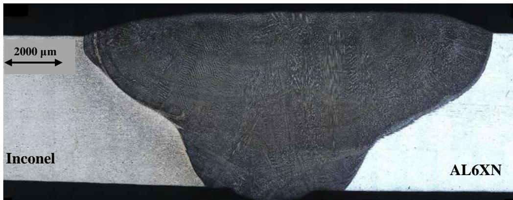
**Figura 4.10.** Vista transversal de macrografía de la unión disímil entre el Inconel 600 y la aleación AL6XN.
