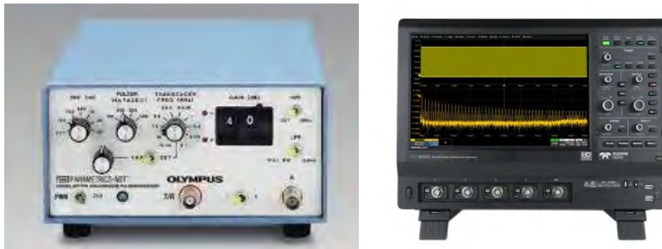
Figura 3.2 Equipo utilizado para medir el tiempo de vuelo de la onda ultrasónica (a) pulsador/receptor y (b) osciloscopio.
