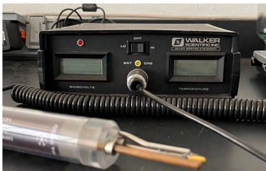
Figura 3.7 Equipo utilizado para realizar mediciones de termoelectricidad.
