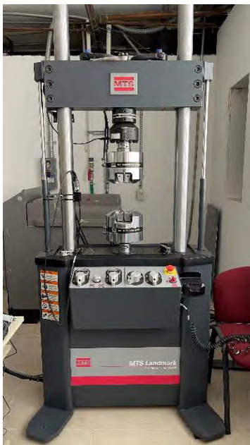
Figura 3.13 (a) Máquina de ensayos universal y (b) Dimensiones de la probeta para ensayos de tensión del AIDL 2101.
