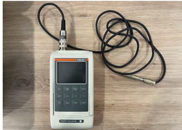
Figura 3.11 Equipo utilizado para realizar las mediciones de ferrita equivalente.
