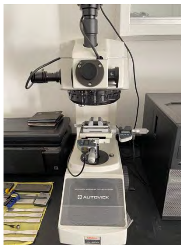
Figura 3.12 Equipo utilizado para realizar mediciones de microdureza.
