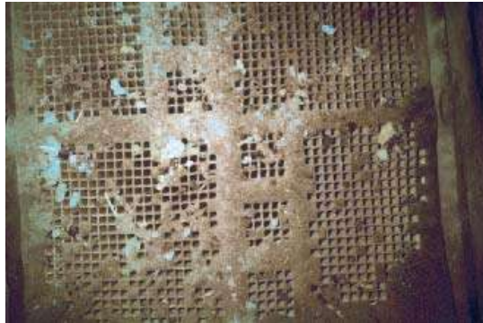
Figura 3-1. Ensuciamiento de un catalizador SCR.
