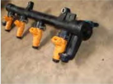
**Figura 3.11** Inyectores y tubo de distribución de combustible utilizado en el Chevrolet Astra Brasil.
