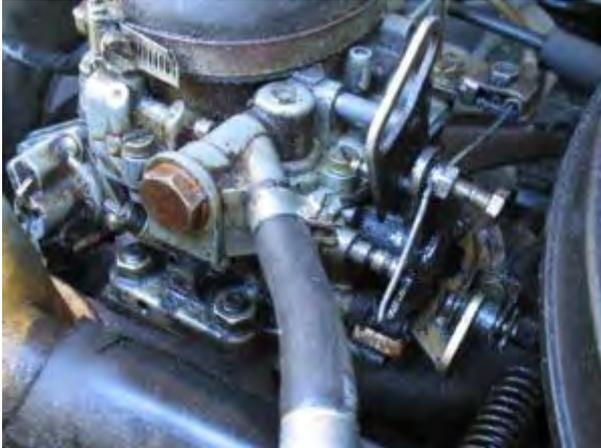
**Figura 3.2** Carburador de automóvil.
