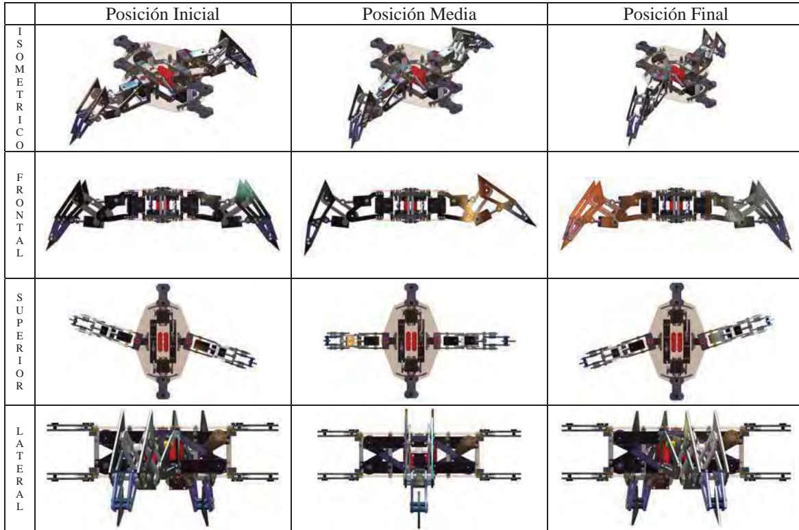
Figura 4.4 Desplazamiento de la parte media del robot en la trayectoria frontal.
