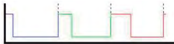
Figura 7.3 PWM para recorrer todo el rango de operación del servo
