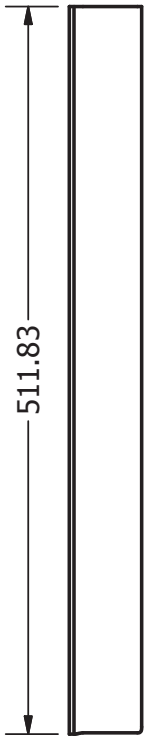
ELEMENTO MSA-SD1.005 ÁNGULO 2x2x1/8 ESCALA 1:5
