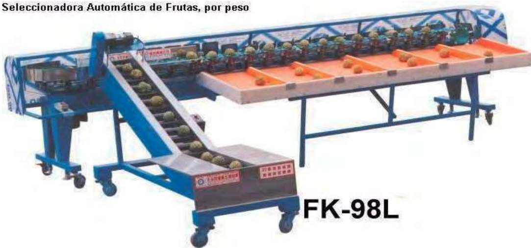
Figura 1. 7 Máquina seleccionadora de frutas a través de rodillos de la empresa FRUTIMAQ.
