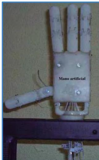
**Figura 1.2.** Prototipo mano artificial.
