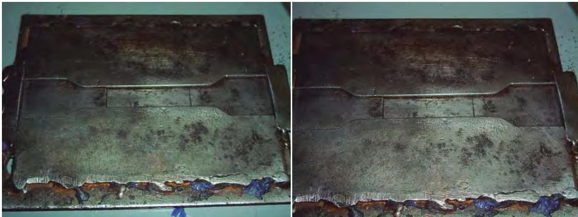
**Figura 3.27.** Molde para fabricar las probetas.
