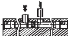
2. Poner los casquillos en la posición correcta para fijar el disco obturador.
