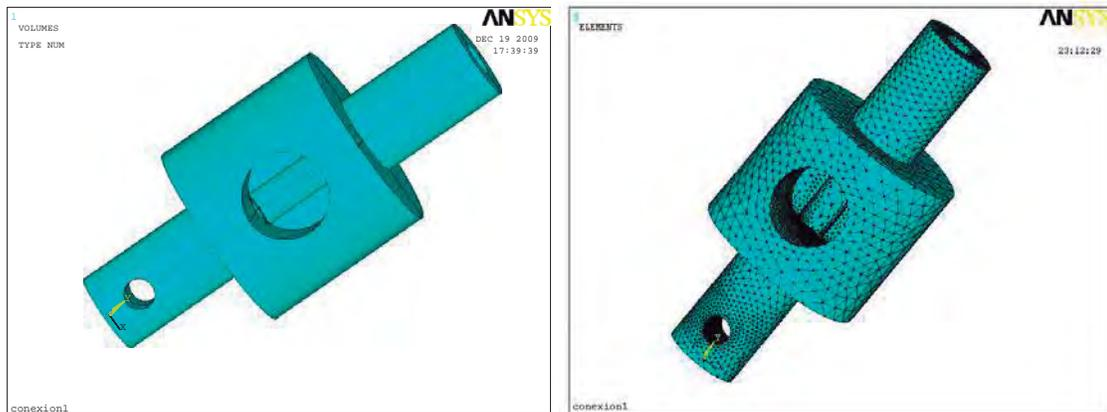
FIGURA 3.51. Mallado y aplicación de cargas.
