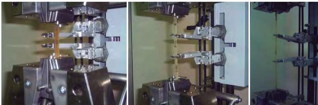
**Figura 3.33.** Ensayo de probeta de látex.
