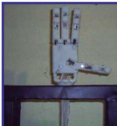
**Figura 3.2.** Mano artificial mostrando los cables que permiten el movimiento de la mano artificial.
