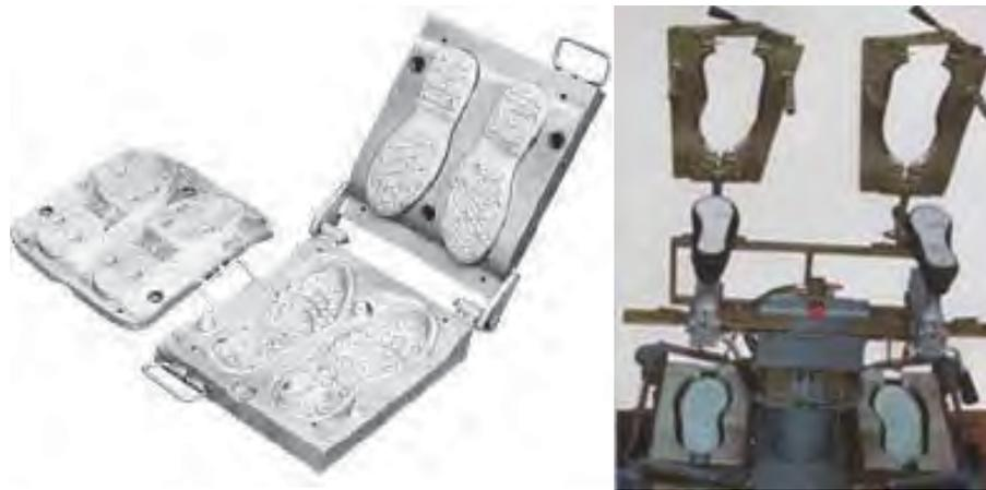
**Figura 3.44.** Moldes para vulcanizado de suela de zapato.
