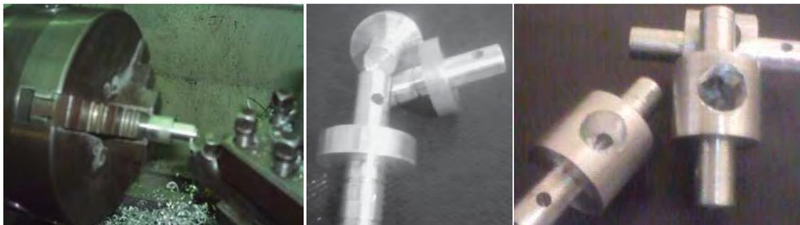
FIGURA 3.54. Conexiones parte inferior y superior del músculo.
