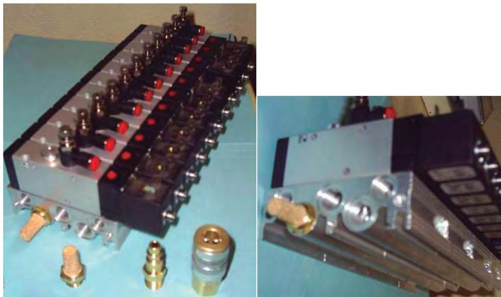
Figura 3.57. Sub-base NORGREN con las electroválvulas.
