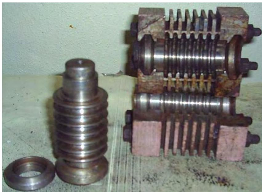
**Figura 3.45.** Molde para Vulcanizar un tubo corrugado de silicón.
