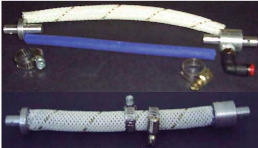
**Figura 4.2.** Parte del músculo recubierto con la malla.
