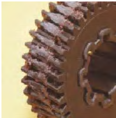
Fig. 18 - Deformación del diente debido al excesivo calor. [15]
