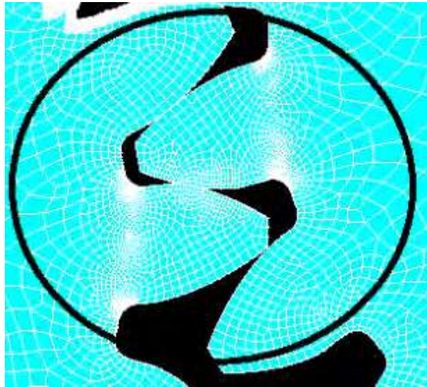
Fig. 27.- Refinamiento del mayado.
