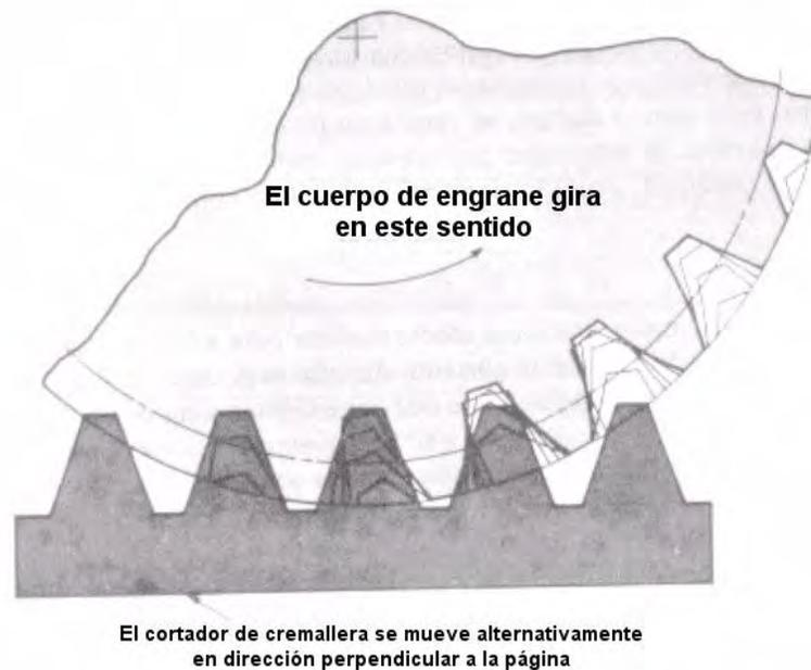
**Figura 1.5. Tallado de un engranaje por generación con cremallera.**
