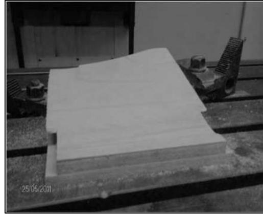
Figura 4.24 Mecanizado de la cama falsa del modelo. Figura 4.25 Cama falsa del modelo ya terminado.
