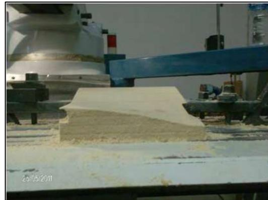
Figura 4.26 Mecanizado de la parte inferior del modelo. Figura 4.27 Parte inferior del modelo ya terminado.
