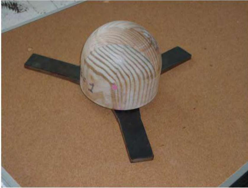
Figura 3.30 Hub aerodinámico montado en el hub mecánico.
