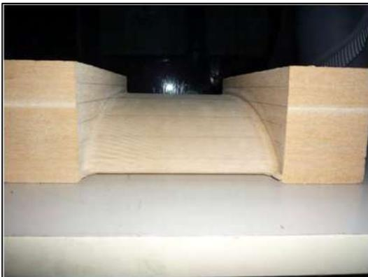
Figura 4.22 Álabe de sección transversal constante.
