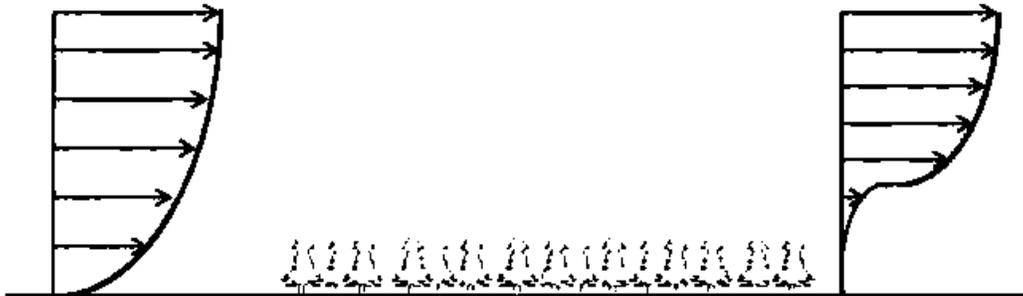
**Figura 1.12.** Efecto de la superficie rugosa en el perfil de rugosidad del viento
