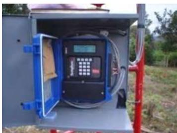
**Figura 1.9.** Aparato de adquisición de datos de viento (Datalogger)
