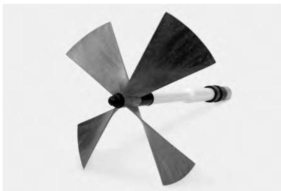
**Figura 1.6.** Anemómetro de propela, para la medición de las tres componentes de la velocidad del viento
