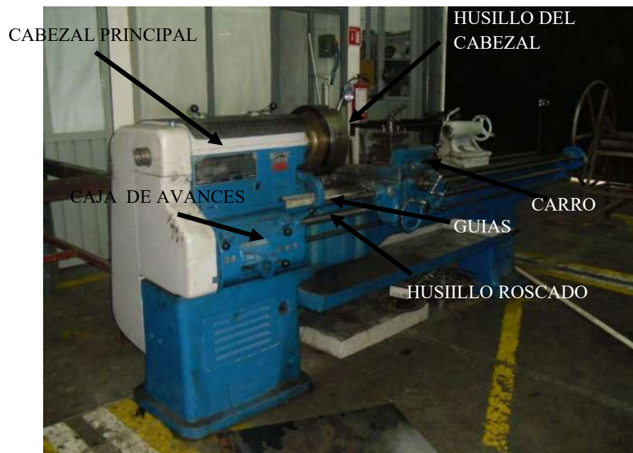
Figura 3. 1. Partes que conforman a un torno paralelo
