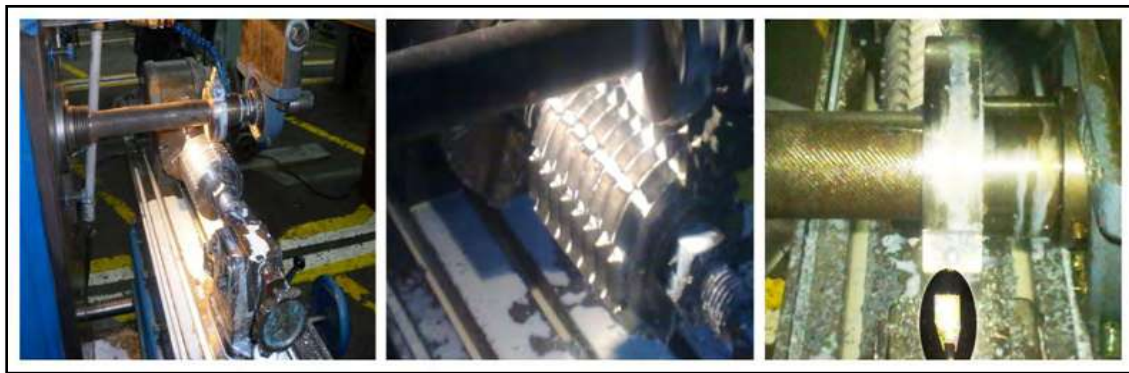
Figura 3.16. Fresado de las ranuras longitudinales.
