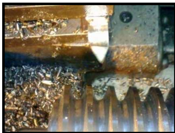
Figura 3. 9. Tallado de la espira del tornillo sinfin.
