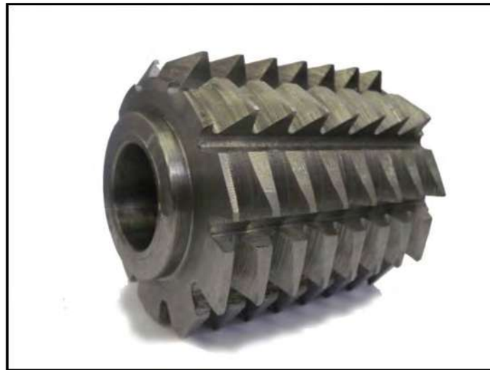
Figura 3. 19. Fresa madre de módulo 5 mm.
