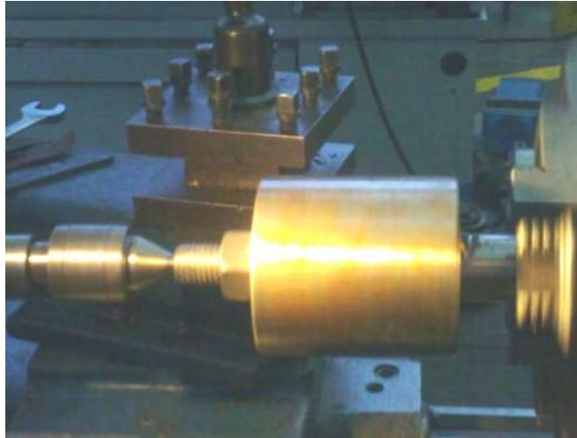
Figura 3. 8. Montaje de el material para el tallado de la espira del tornillo sinfin.
