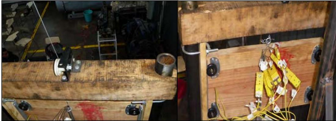
**Figura 3.7.**-Polea y carrera con 4 llantas.
