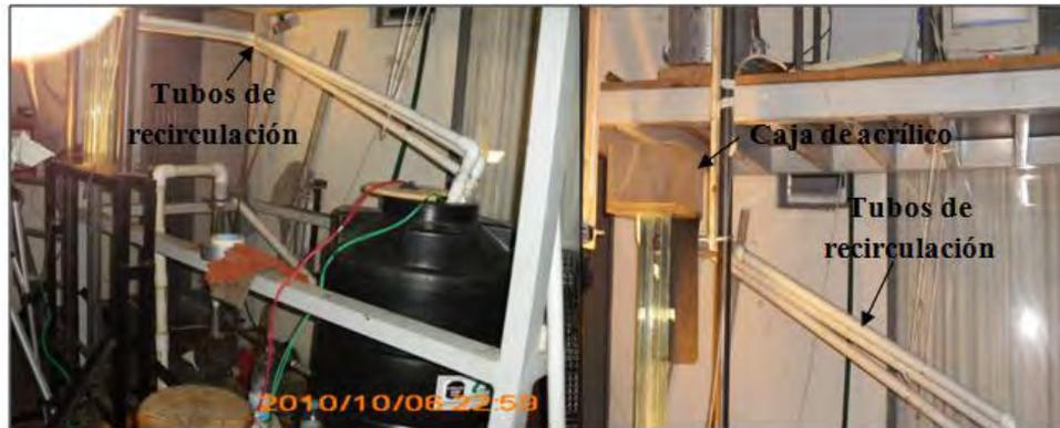
Figura 3.12.- Caja de acrílico y tubos de recirculación.
