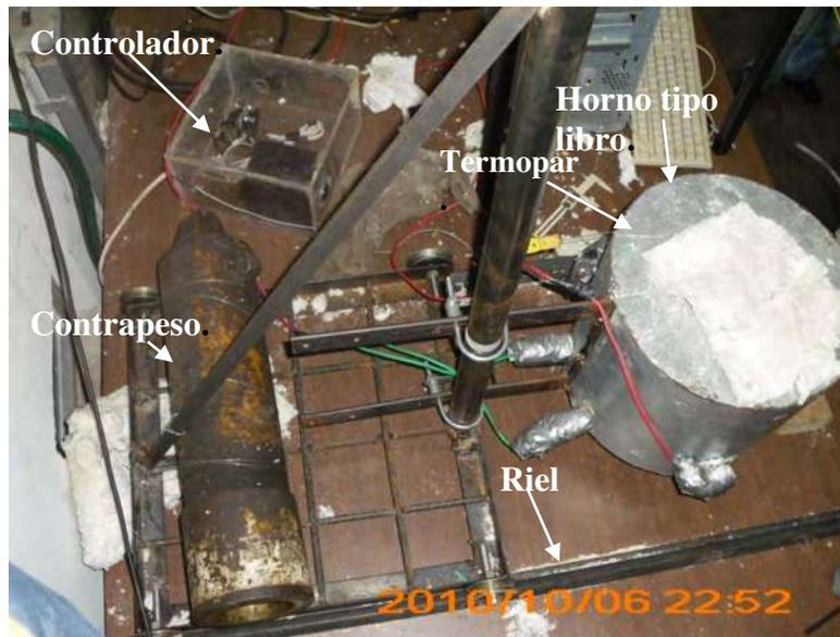
**Figura 3. 19-** Montaje del horno.
