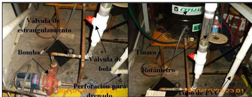
**Figura 3.10.-**Componentes hidráulicos del sistema.
