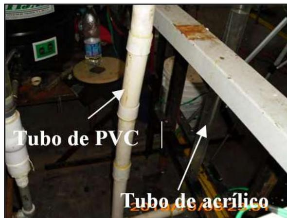
Figura 3.11.-Conexión PVC y acrílico.
