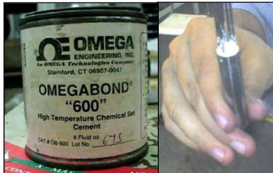
Figura 3. 31-Cemento utilizado y sellado de la probeta.
