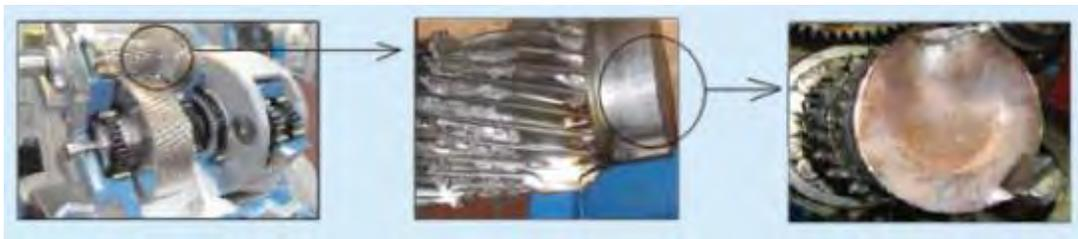
**Figura 1.14.** Flecha rota en la etapa intermedia de la caja de cambios de un aerogenerador.
