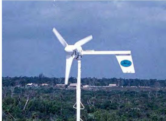
**Figura 1.18.** *Aerogenerador Avispa. 500 W de potencia.*
