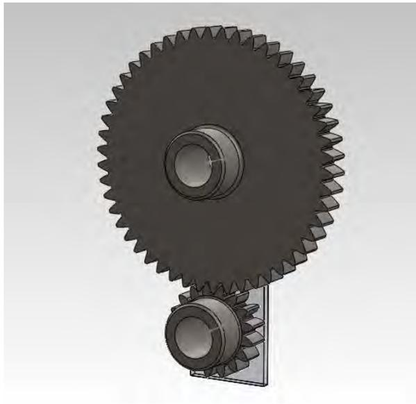
**Figura 3.10.** *Ensamble entre engranes de 17 y 51 dientes.*
