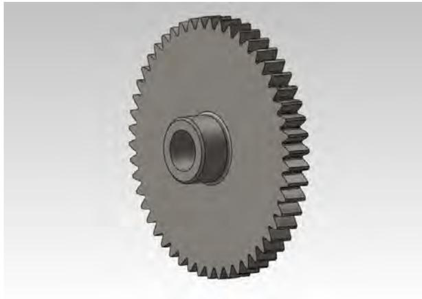
**Figura 3.8.** *Diseño final del engrane asimétrico de 50 dientes.*
