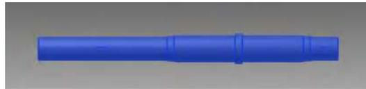
**Figura 3.19.** Modelado 3D y disposición de los hombros del eje número 6.
