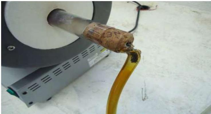
**Figura 9** Daño sufrido en la manguera por la alta temperatura del flujo.
