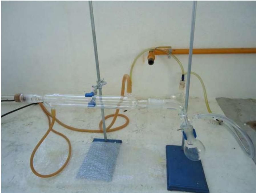
**Figura 13** Adaptación del tubo y condensador para evitar que se dañe la manguera.
