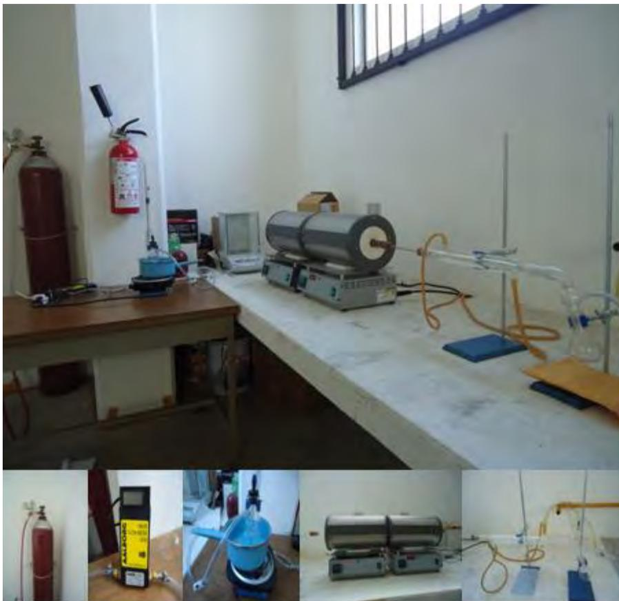
**Figura 8b** Reactor para producción de nanotubos de carbono.
