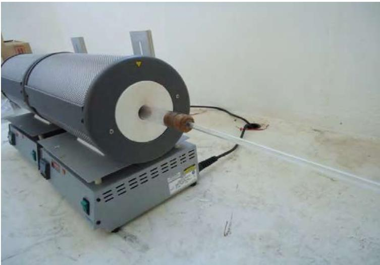
**Figura 11** Adaptación del tubo para evitar que se dañe la manguera.
