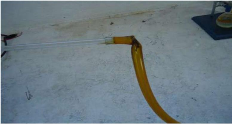
**Figura 12** Daño sufrido en la manguera por la alta temperatura del flujo.
